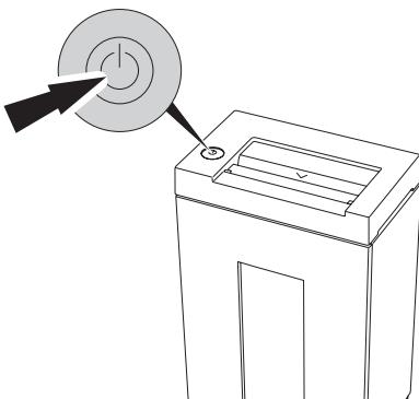
**DE** Autom. Standby - Abschaltung nach 15 Minuten. Maschine kann jederzeit durch Drücken des Schalters ausgeschaltet werden. Grüne Kontrollleuchte erlischt. Danach verbraucht die Maschine keinen Strom mehr. Innerhalb dieser 15 Minuten verbraucht der Aktenvernichter folgende Wh Energie.
