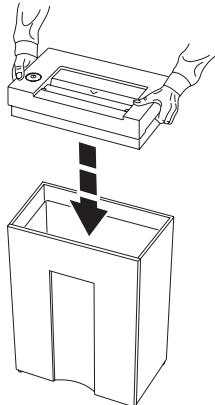
**DE** Maschine in den Auffangbehälter setzen.
