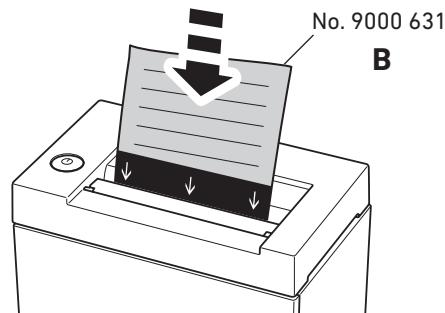
**DE** Bei jedem gefüllten Auffangbehälter oder bei nachlassender Schneidleistung Schneidwerk ölen.
